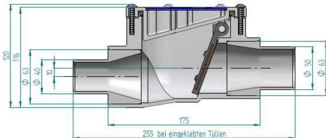
Durch die kompakte Gehäusegeometrie ist der Einsatz dieser Rückschlagklappe in vielen Bereichen der Wasser- und Abwasserführung und der Granulatförderung auch bei beengten Einbauverhältnissen möglich. Durch die Auslegung des Anschluss-Innendurchmessers auf Ø 63mm können handelsübliche Rohrsysteme direkt eingeklebt werden. Die Reduzierstutzen mit Aussen-Ø 50mm und Ø 40mm ermöglichen eine sehr variable Anschluss- und Reduziermöglichkeit.
